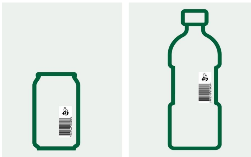
Abbildung 5: Beispielhafte Darstellung von vertikaler Platzierung des EAN/UPC Barcodes und Pfandsymbols auf Dose und Flasche
