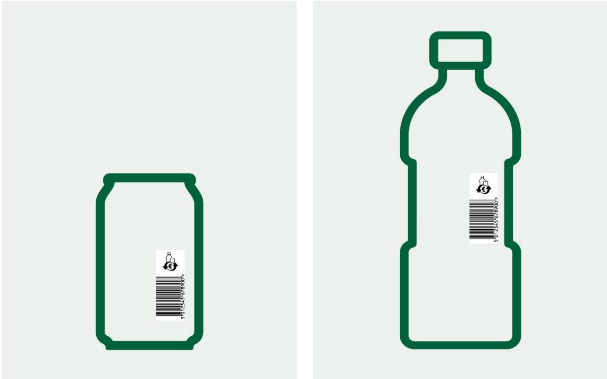
Abbildung 4: Beispielhafte Darstellung von vertikaler Platzierung des EAN-Barcodes und Pfandsymbols auf Dose und Flasche
